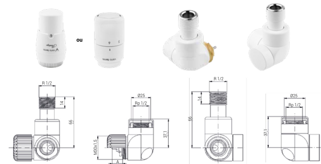
Kit thermostatique LUX I, version axiale, droite ou gauche. F ½" x M ½". Inclus dans l'ensemble: 1 x robinet thermostatique LUX I, 1 x robinet d'arrêt LUX I, 1 x tête thermostatique PRESTIGE ou TUCAN.
