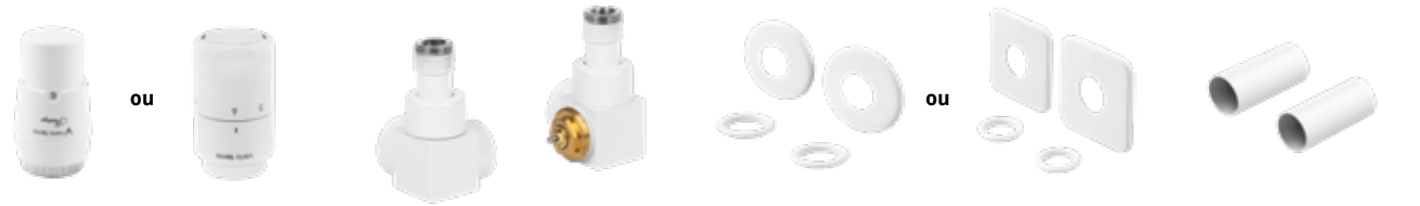
Kit thermostatique QUATTRO, version axiale, droite ou gauche. F ½" x M ½". Inclus dans l'ensemble: 1 x robinet thermostatique QUATTRO, 1 x robinet d'arrêt QUATTRO, 1 x tête thermostatique PRESTIGE ou TUCAN, 2 x rosettes de masquage simples, rondes ou carrées, 2 x tubes de masquage. Les raccords PEX (16x2) ou Cu (15x1) font partie intégrante des robinets. Lors de la commande, ajoutez (PEX) ou (Cu) à la fin du numéro de catalogue, par exemple: AKQGS0229CFK/P(PEX).
