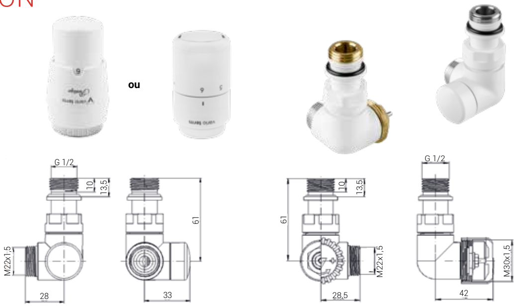
Kit thermostatique VISION, axial. Version gauche ou droite. M ½" x M22x1,5 M. Inclus dans l'ensemble: 1 x robinet thermostatique VISION, 1 x robinet d'arrêt VISION, 1 x tête thermostatique PRESTIGE ou TUCAN.
